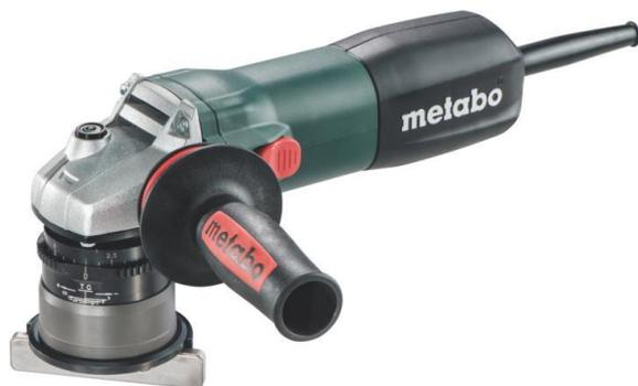
Mit nur 2,5 Kilogramm Gewicht ist die neue Metall-Kantenfräse KFM 9-3 RF von Metabo besonders handlich. Dank des patentierten One-Touch-Controllers lässt sich die Fasenhöhe werkzeuglos mit nur einem Handgriff auf den Zehntelmillimeter genau einstellen und ist durch die integrierten Rastpunkte während des Arbeitens dauerhaft fixiert. **Foto: Metabo**
