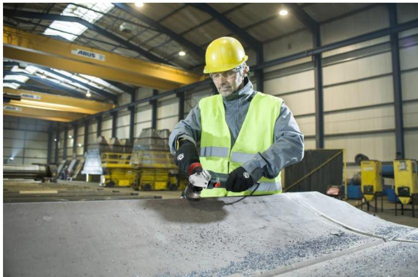
Ob mit Akku oder Kabel: Mit den neuen Kantenfräsen von Metabo bearbeiten Handwerker Metallkanten besonders schnell und kostengünstig – und erzielen dabei perfekte Oberflächenergebnisse. **Foto: Metabo**
